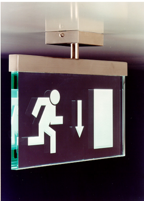
Rettungszeichenleuchte, Gehäuse Edelstahl geschliffen; Piktogramm FLOAT-Glas tiefgestrahlt (auch Folie n. DIN) 230V;AC50Hz/DC; Leistungsaufnahme 3,5W; LM weiße LED - 5 Kreise, Lebensdauer > 50.000h bei Dauerbetrieb
